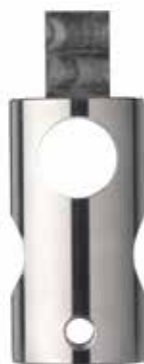
Dreh-Frästeil aus Automatenstahl mit Vierkant → Ø 25 mm × 65 mm
