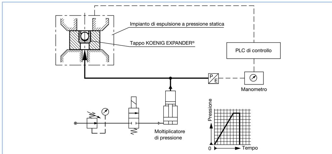
Durante la prova A di collaudo il tappo KOENIG EXPANDER® viene sollecitato a pressione statica fino ad essere distrutto o espulso. Questa prova viene eseguita da SFC KOENIG per verificare la funzionalità durante il processo di produzione.
