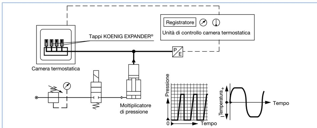
Durante la prova B di collaudo il tappo KOENIG EXPANDER® viene sottoposto per un lungo periodo a condizioni simili a quelle di un utilizzo reale. In questo modo si definisce la pressione alla quale il tappo può resistere senza essere espulso in caso di sollecitazioni a pressione intermittente e con variazioni di temperatura.
