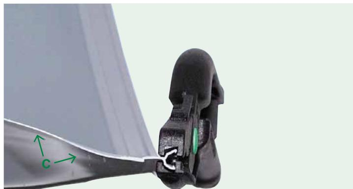
4. Z-Zange locker halten und ca. 20 mm über U-Profil führen.
