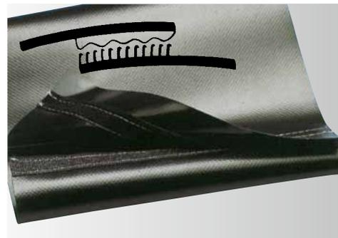
Der Z-, R- und M-Verschuß ist aus PVC, der Klettverschuß (G-Verschuß) ist aus Polyamid hergestellt. Die PVC-Verschlüsse können mit unserem RSQ-Kleber fest verschweißt werden. Nach einer Trockenzeit von ca. 12 Stunden ist dann eine Demontage nicht mehr möglich. Flaschen à 50 ccl und à 100 ccl.
