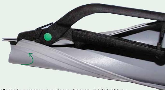
5. Pfeilseite zwischen den Zangenbacken, in Pfeilrichtung (s. auch Z-Zange), in das U-Profil einführen.
