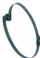
Le fascette senza fine a doppio ponte sono particolarmente adatte ai tubi spiralizzati destinati al passaggio dell'aria. Realizzate in acciaio inossidabile AISI-304, sono adatte alle applicazioni nelle condizioni più difficili. Su richiesta, le fascette senza fine sono disponibili anche in acciaio zincato (versione W2) a ponte semplice.
