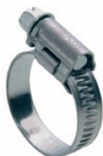
Le fascette ASFA-L grazie alla particolare struttura della gabbia sono caratterizzate da eccellenti proprietà tecniche e da una forma compatta. Lo stampaggio esterno del nastro e la superficie interna liscia, insieme ai bordi arrotondati, consentono di evitare possibili danni ai tubi flessibili.
