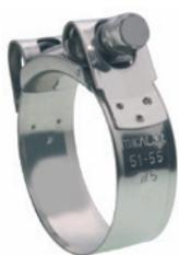
I collari a bullone SUPRA sono l'evoluzione della storica fascetta SUPER. Grazie al loro ponte pieghevole, il montaggio può essere eseguito evitando di dover smontare il tubo. Gli elementi del ponte sono fissati in modo tale da non poter andare persi. I bordi rialzati impediscono un possibile danneggiamento del tubo.
