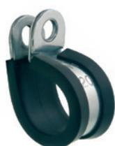
Le fascette denominate P-Clip sono fabbricate a partire da un nastro di acciaio con un inserto di gomma nero (EPDM). Il profilo in gomma assolve molteplici funzioni: garantisce una buona tenuta, riduce il rischio di lesione, attenua le vibrazioni ed evita eventuali ristagni di acqua. In corrispondenza dei fori, la fascia è rinforzata.
