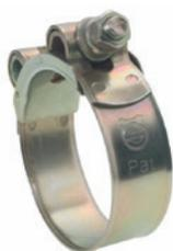
I collari a bullone SUPER sono stati realizzati appositamente per offrire una forte resistenza alle alte pressioni. Il sistema di serraggio è basato su una vite orientabile con classe di resistenza 8.8 e un dado esagonale. La fascia con i bordi arrotondati impedisce un possibile danneggiamento del tubo.
