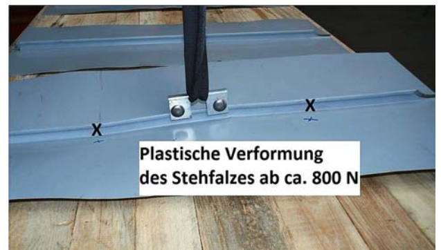
Zugversuch mit Falzklemme zwischen zwei Haften (x).
